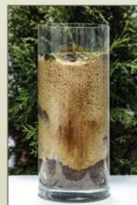
t=20-30 min całkowita likwidacja kanału uziomu połączenie z głębszą warstwą o lepszej przewodności
