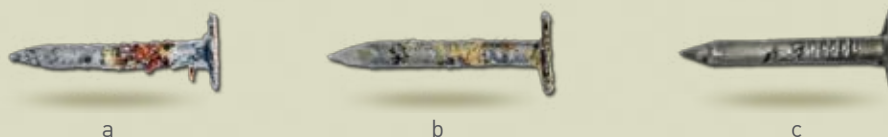
Zdj. 3 Petna, nieuszkodzona powłoka anodowa po 574 godzinach pobytu w różnych środowiskach a) słone b) zasadowe c) kwaśne
