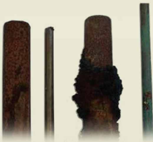
Zdj. 6 Budowa kokonu rdzy. Stan t \approx 30 min
