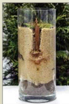
t=10-15 min rozwój szybkiej korozji chemicznej
