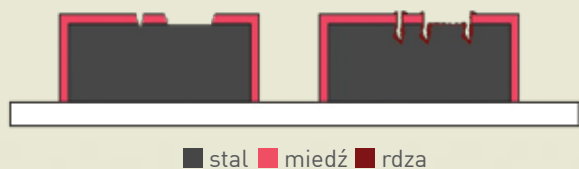
Rys. 2 Działanie powłoki katodowej
