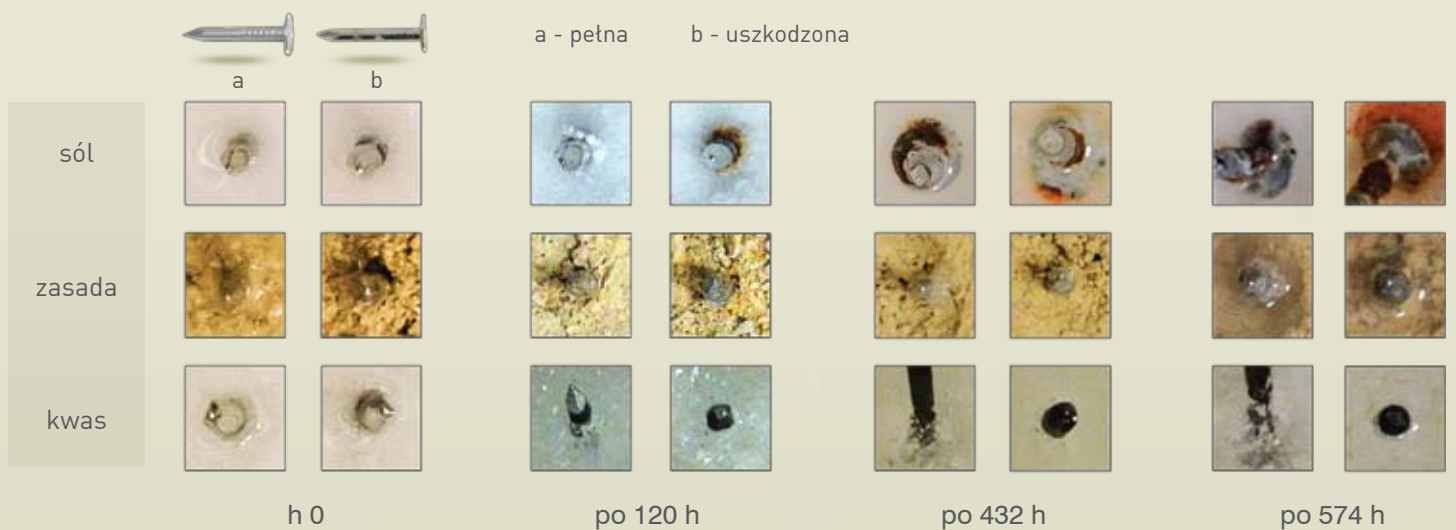
Zdj. 2 Zachowania powłoki anodowej w różnych środowiskach
