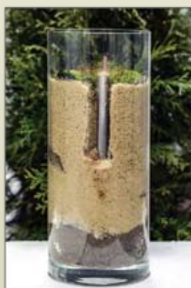
t=5-10 min początek wymuszonej szybkiej korozji chemicznej
